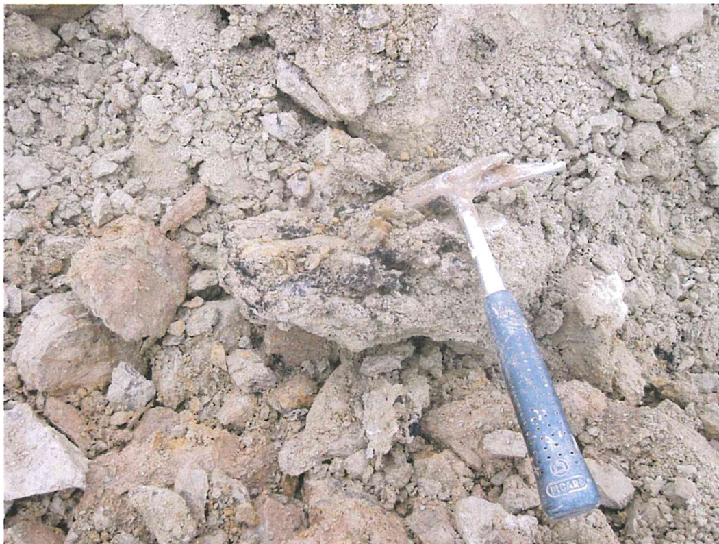
Bild 9: vereinzelte dunkelbraune / schwarze, organische Beimengungen im Probenmaterial von Schurf 3 (Probe SCH 3/3 – 3/4)
