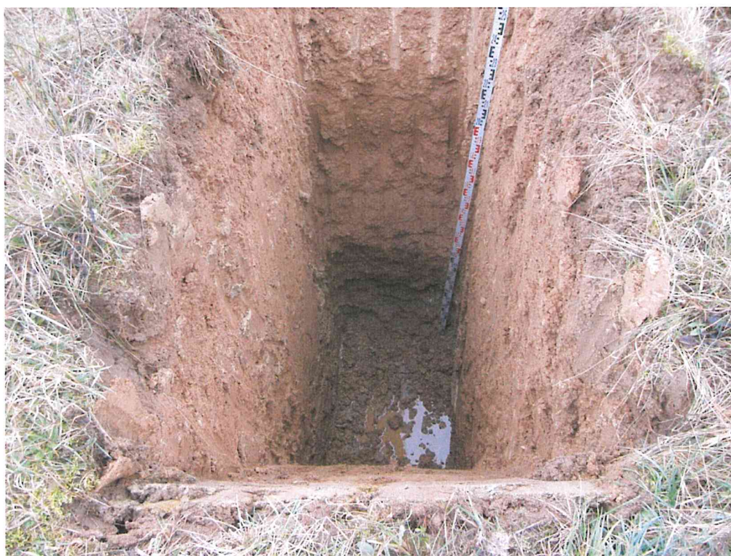
Bild 10: Schurf 4 bei RKS 10, deutliche Ansammlung von Schichtwasser (unmittelbar nach der Schurfherstellung)
