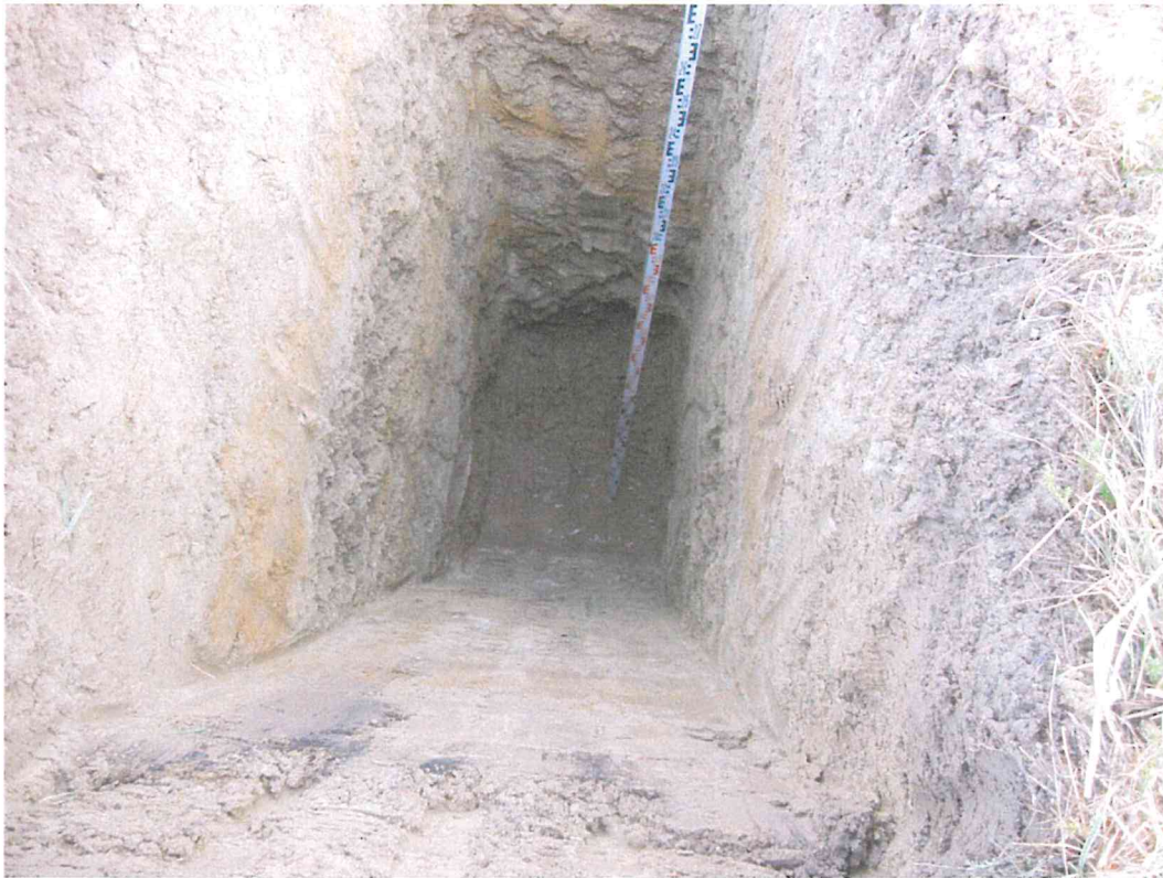
Bild 7: Schurf 3 bei RKS 8, deutliche Schichtwasserzutritte, die sich an der Schurfsohle sammeln
